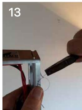
6. Coupez l'excédent de fil du nœud que vous venez de faire, retirez l'isolant de l'outil et accrochez la poignée à ressort dans le premier œillet de la barre supérieure de distribution de courant, photo 14. Insérez maintenant l'isolant à travers le trou central des supports de la barre isolante et déplacez l'isolant jusqu'à sa position finale, photo 15.
